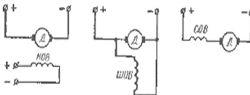
30. Номинальный ток двигателя постоянного тока с последовательным возбуждением  $I_{ном} = 50 \text{ A}$ . Чему равен ток обмотки возбуждения?
